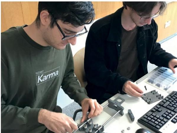
Stahlstangen, Gewinde, Kugellager und Riemenbänder bilden die Grundlage für den Zeichen-Roboter.
