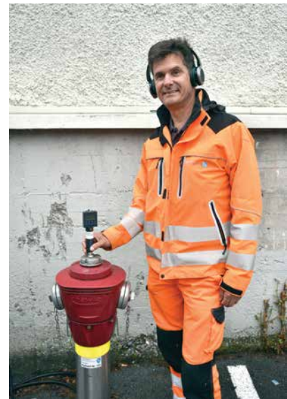
Bernhard Quendler spürt mit Hilfe eines Mikrophons den Wasserrohrbruch auf
